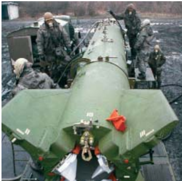
Vue de l'arrière d'un Scud-B russe, avec le détail des déflecteurs de jet (en graphite, de couleur argentée) qui servent au pilotage du missile, les dérives (en vert) étant fixes
