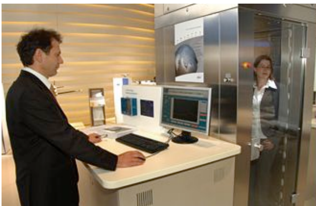
Présentation "grandeur réelle" de la technologie LIMS à l'aide du démonstrateur d'un portique de détection pour passagers. Le spectromètre LIMS est capable de détecter d'infimes traces d'explosifs, de produits chimiques ou de drogues.
